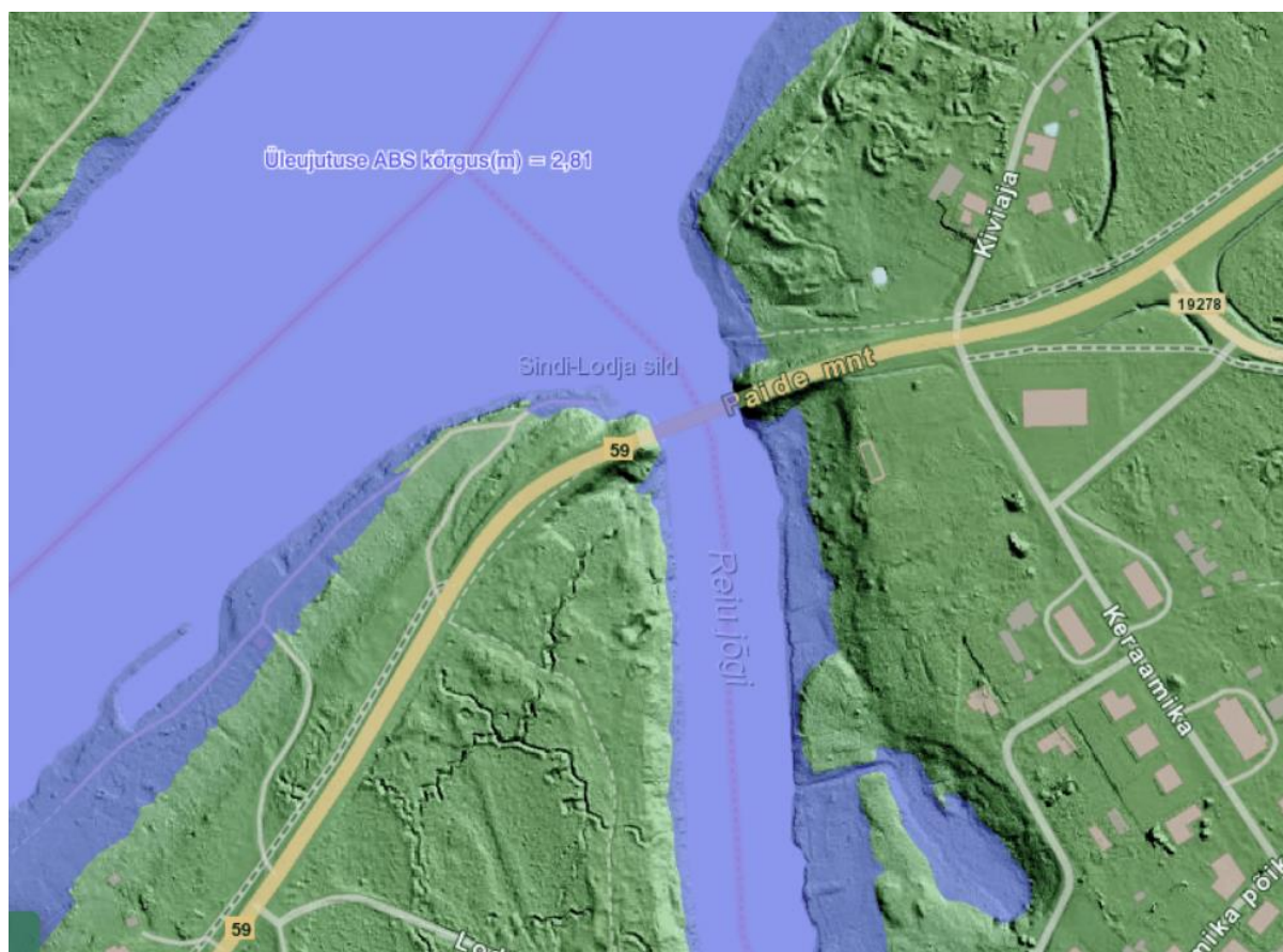
Joonis 2.2. Üleujutatav ala üleujutuse 2% tõenäosuse korral ehk esinemine üks kord 50 aasta jooksul, üleujutusest tingitud veetaseme kõrgus abs 2,81 m (alus: Maa-amet, 2024).
